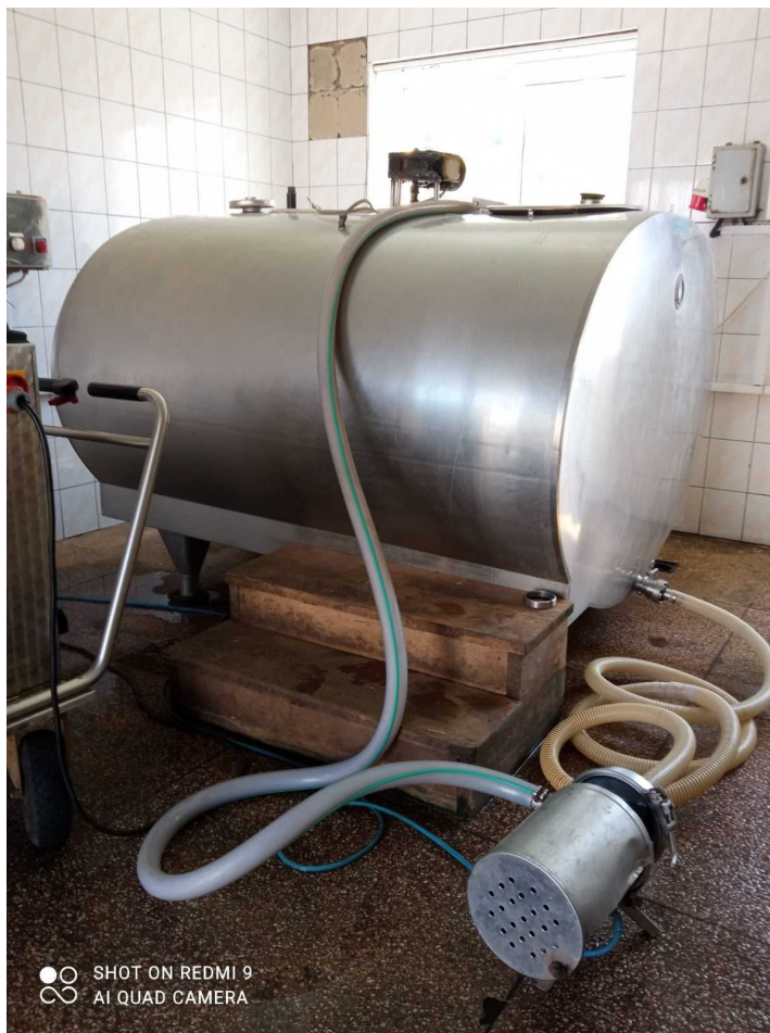
Рис. 3.10. Резервуар для зберігання молока
