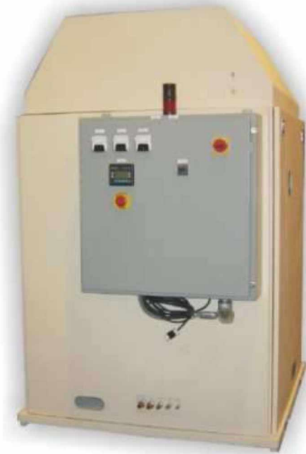
Рис. 1.3 – Система рециркуляції абразивного піску [18]
