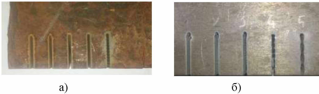
Рис. 3.4 – Зразки для вимірювання ширини різку ( а – сталь, б – алюміній)
