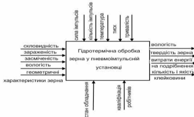
Рисунок 3.3 Параметрична модель процесу ГО зерна
