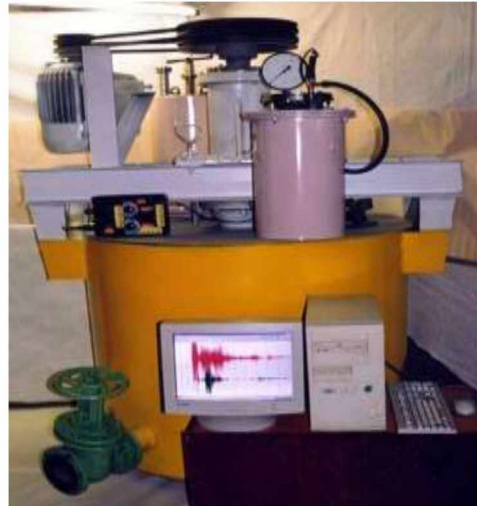
Рисунок 2.2 Пневмоімпульсна установка ГО обробки зерна пшениці
