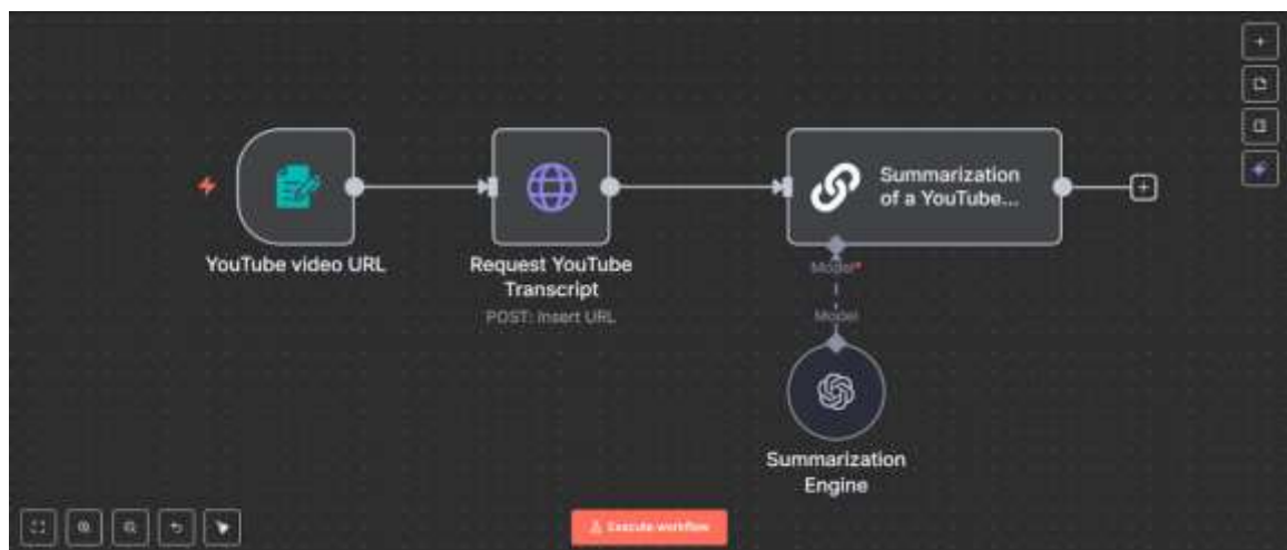
Рисунок 2.3 – Робочий процес n8n, що автоматизує процес створення короткого змісту YouTube-відео
