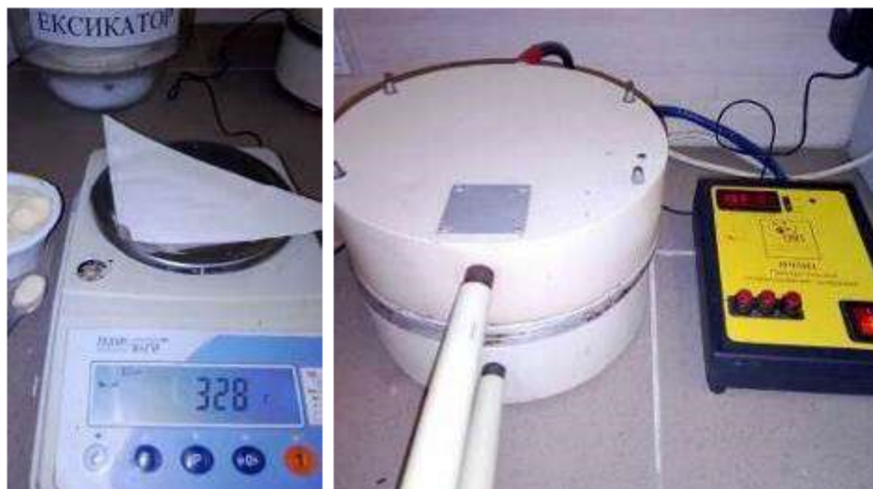
Рис. 2.4. Визначення масової частки води та сухих речовин
