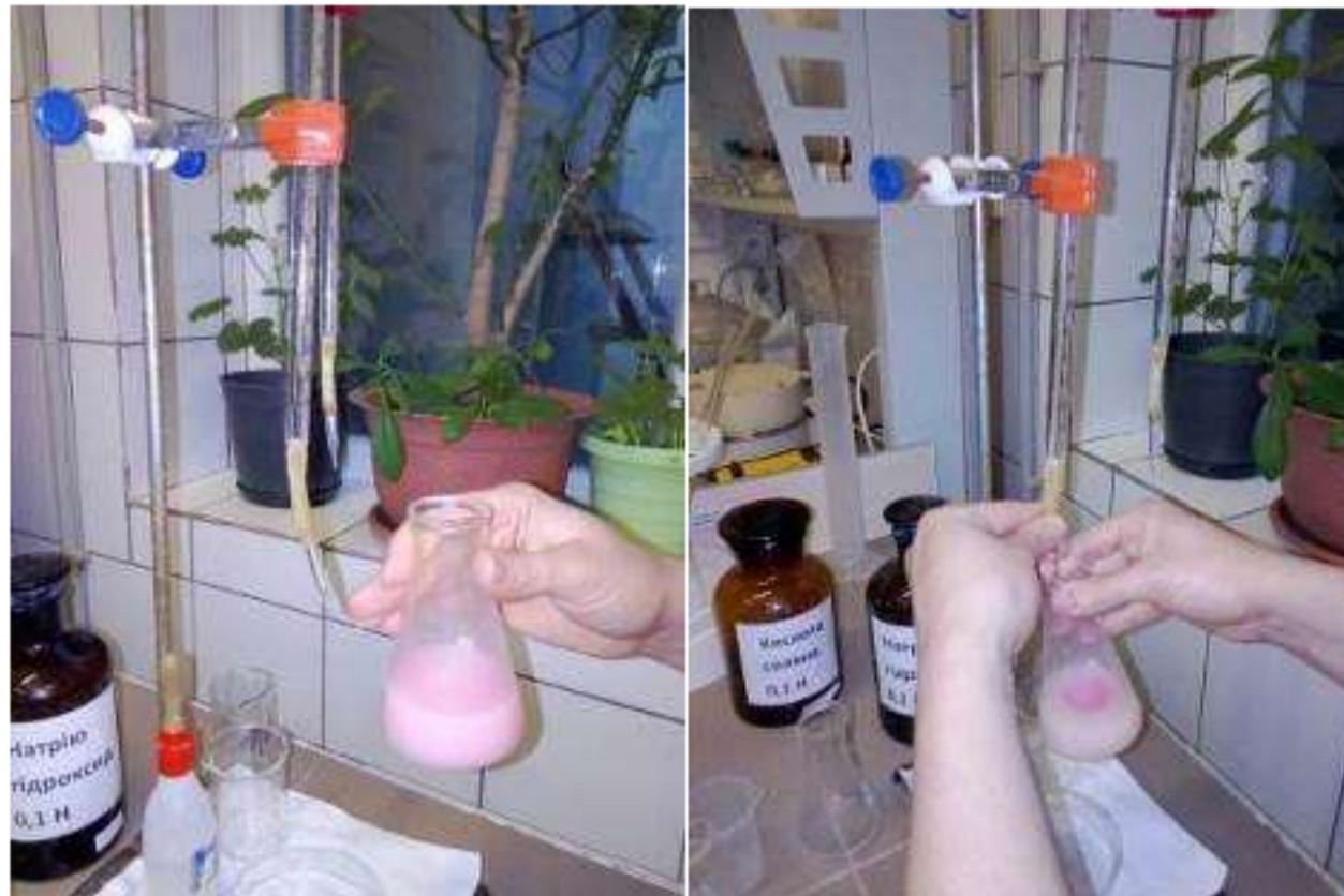
Рис.2.3. Визначення кислотності продукту в умовах лабораторії підприємства
