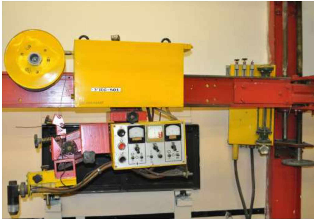
Рисунок 2.4 – Загальний вигляд установки для плазмової обробки деталей
