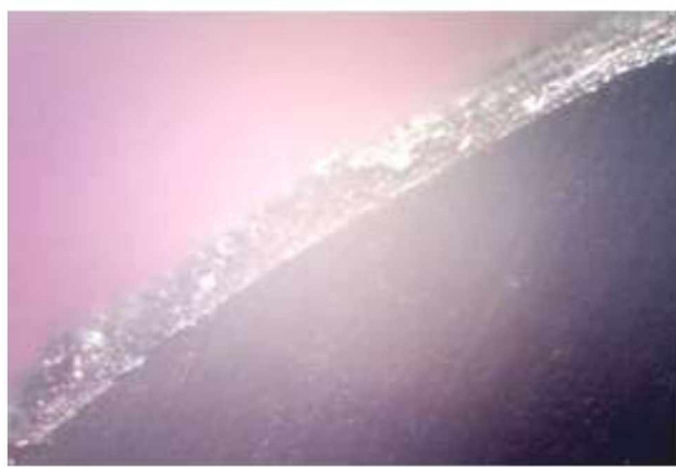
а). - фото зміцненого шару зразка електродуговою металізацією (x100 ) б). мікроструктура поверхневого шару зразка, зміцненого електродуговою металізацією (x300)
