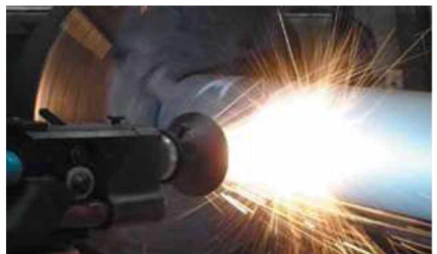
Рисунок 1.4 – Схема установки для лазерного наплавлення
