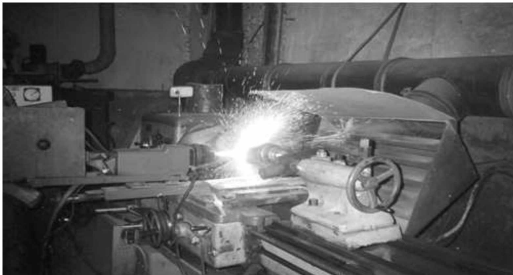
Рисунок 3.4- Схема (а) і зовнішій вигляд (б) експериментальної установки; процес формування покриття (в)
