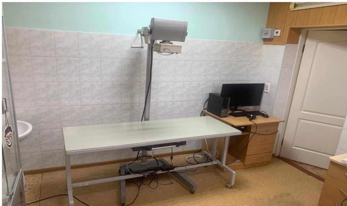
Рисунок 3. Випромінювач – Арман-9 та стіл з електронним приймачем ІОНА-Х.
