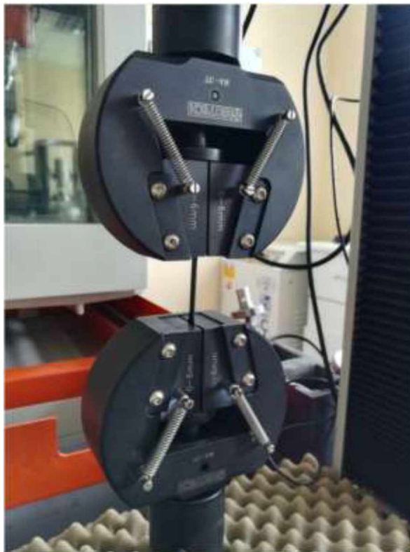
Рисунок 2.2 – Зовнішній вигляд захватів машини при випробуваннях зразків на розтяг
