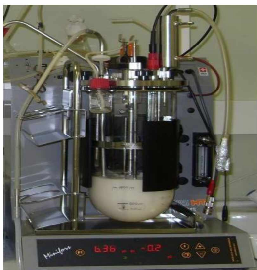
Рис. 3.6 А -Лабораторний ферментер Minifors, Б) Схема ферментера (біореактор) для культивування мікроорганізмів.
