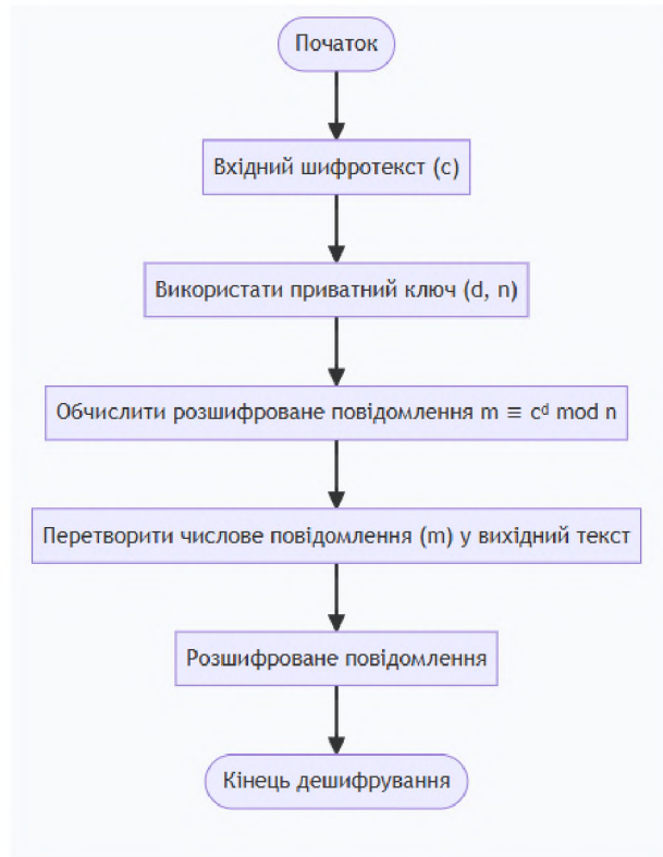
Рисунок 1.3 – Блок-схема етапу дешифрування повідомлення RSA
