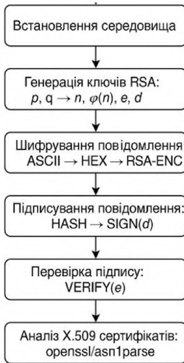
Рисунок 2.1 – Блок-схема послідовності дослідження алгоритму RSA
