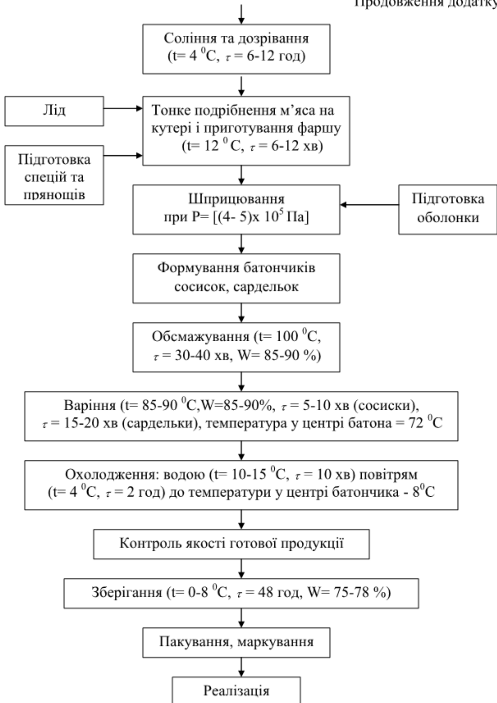
Рисунок А.2 - Технологічна схема виробництва сардельок, сосисок
