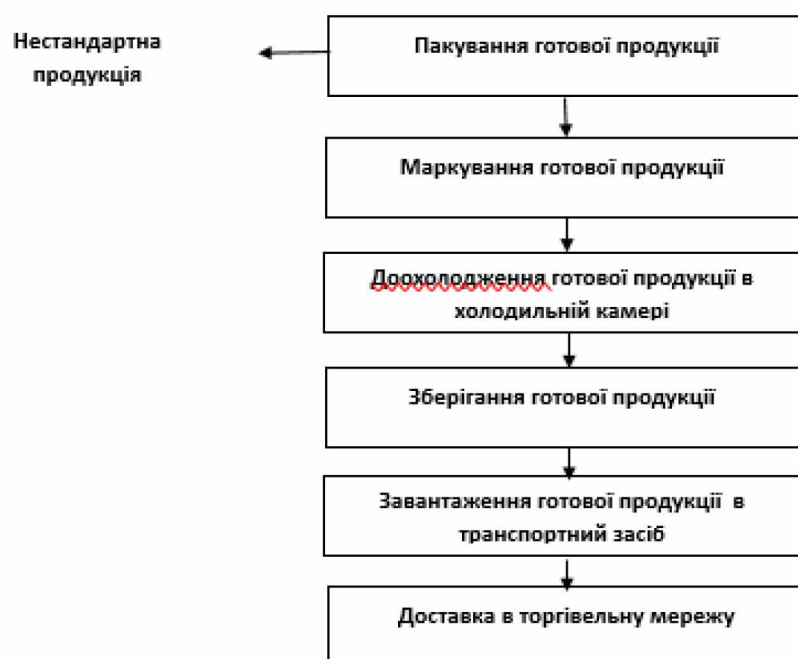
Рисунок 3.6. Технологічна схема виробництва йогурту без добавок
