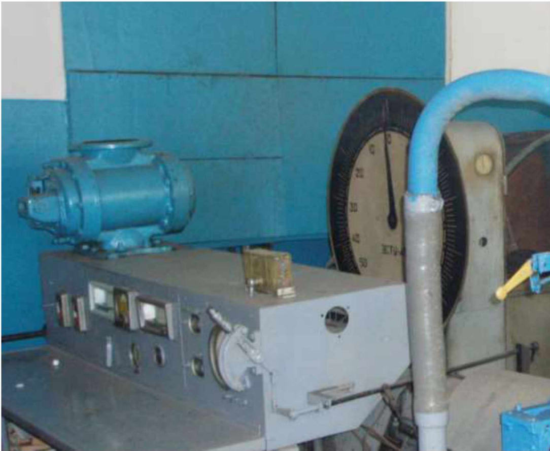
Рисунок 2.3 – Електричний стенд ГОСНИТИ асинхронною машиною типу АК
