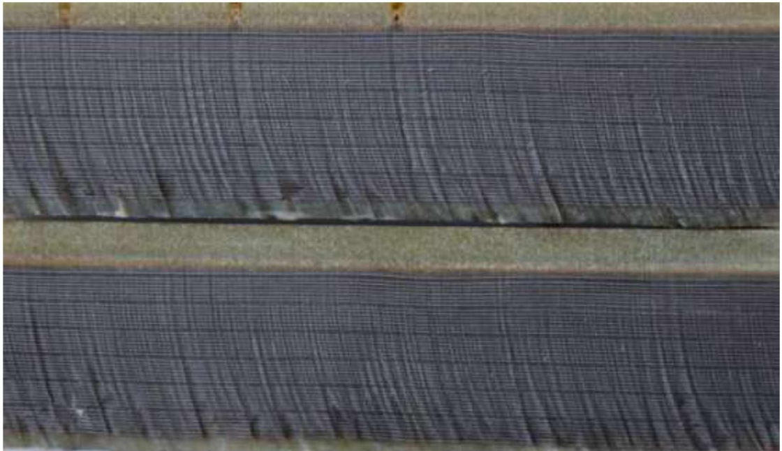
Рисунок 3.5 – Поверхня різку зразків з композитного матеріалу типу склопластик-титан при збільшенні подачі від 5 до 480 мм/хв
