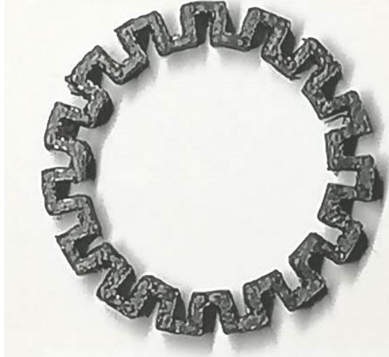
Рисунок 11. 3D-печать шаблона квазифрактального кольцевого вибратора
