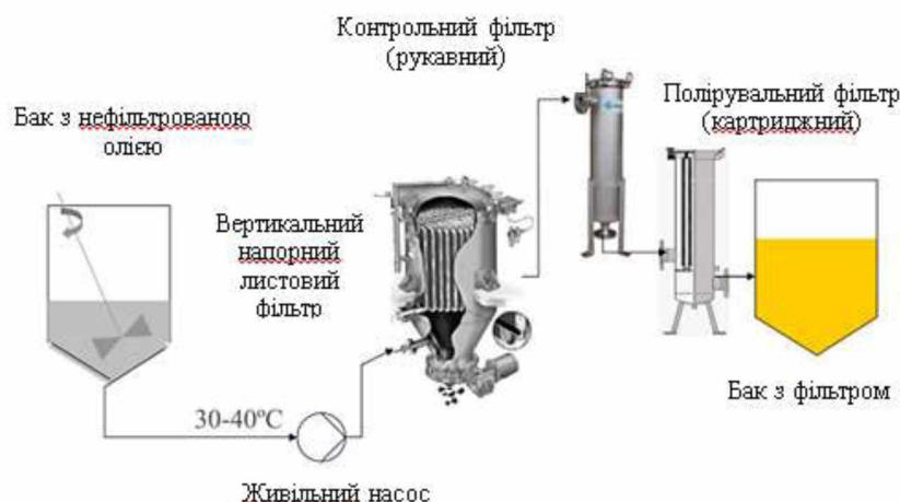
Рисунок 1.4 – Операторна схема очищення нерафінованої олії холодного пресування
