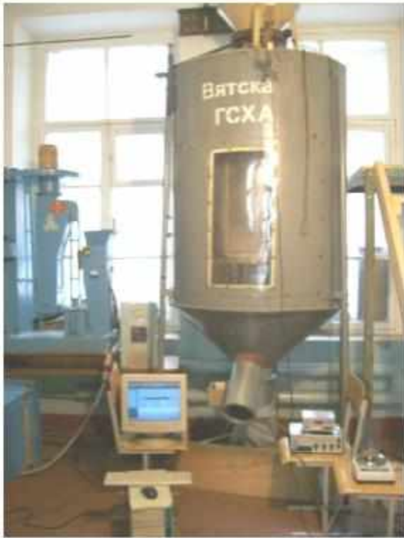
Рисунок 3.2 – Загальний вигляд пневмосепаратора з пристроєм поточного контролю та управління технологічним процесом
