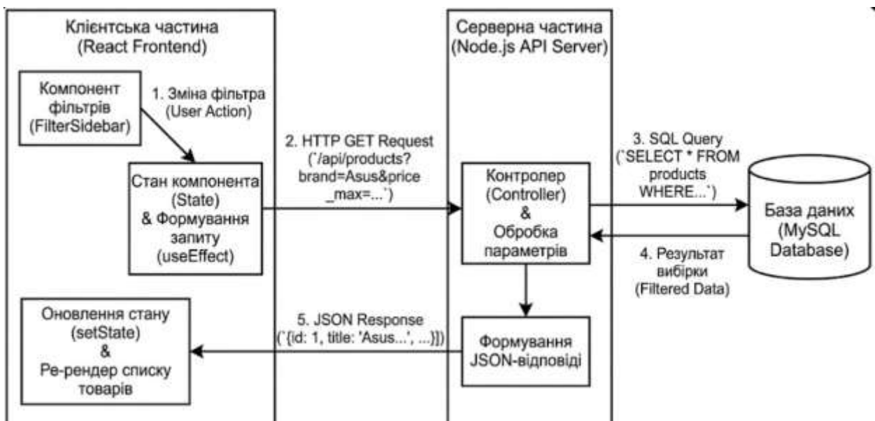
Рисунок 3.3 – Схема взаємодії компонентів фільтрації та API
