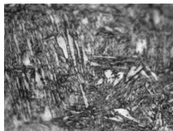
Рисунок 11 – Мікроструктура сталі 5Х3В3МФС після загартування від 1080°C (мартенсит голчастий, аустенит залишковий і карбіди), *500
