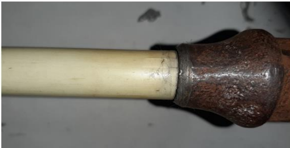
Рисунок 3 – Зародження тріщин на досліджуваному зразку (1,312 млн. циклів)
