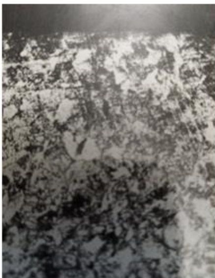
Рисунок 9 - Мікроструктура матричного кільця з сталі 5X3B3MFC після карбонітрації, *600
