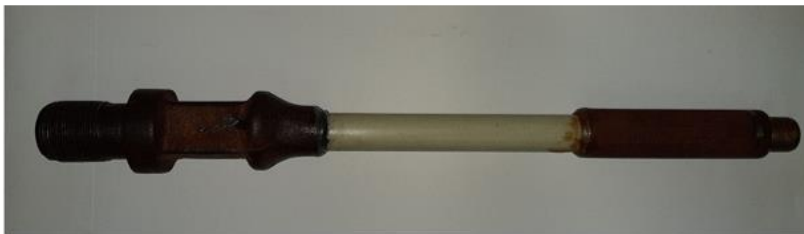
Рисунок 2 - Зразок гібридної штанги для випробування на втому
