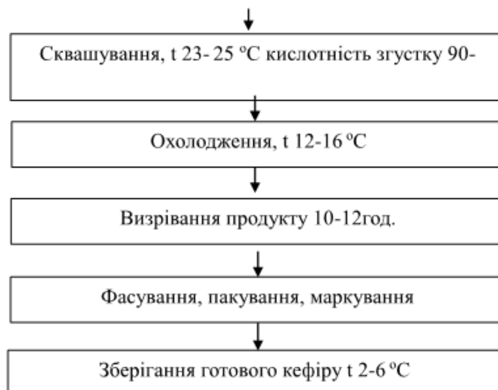
Рисунок 1.2.3. - Технологічна схема виробництва кефіру нежирного
