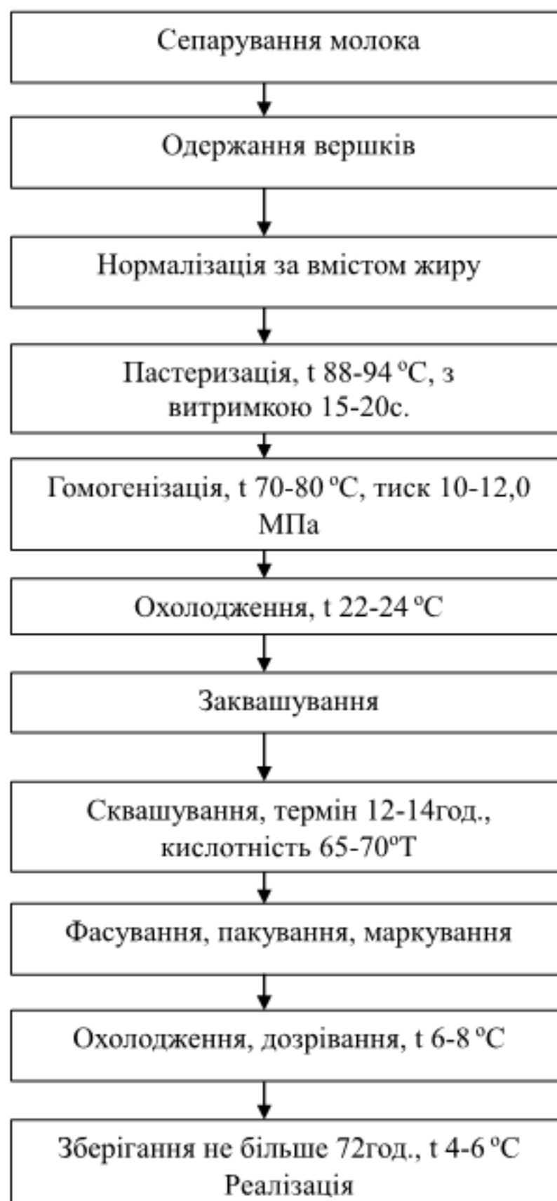
Рисунок 1.2.6. - Технологічна схема виробництва сметани з масовою часткою жиру 15,0%
