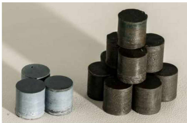
Рисунок 2.4 – Зразки для дослідження властивостей полімерних композиційних матеріалів
