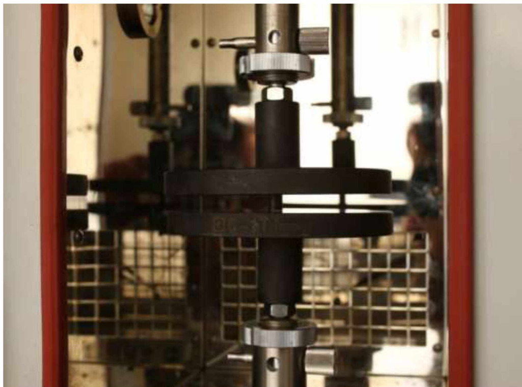
Рисунок 2.5 – Навантаження зразка металополімерної композиції
