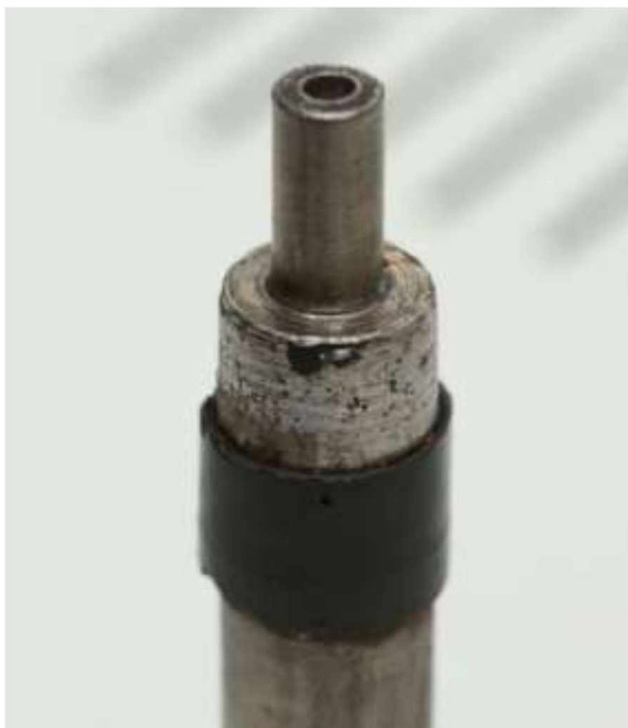
Рисунок 2.2 – Циліндричний зразок з нанесеним на нього металополімерним покриттям
