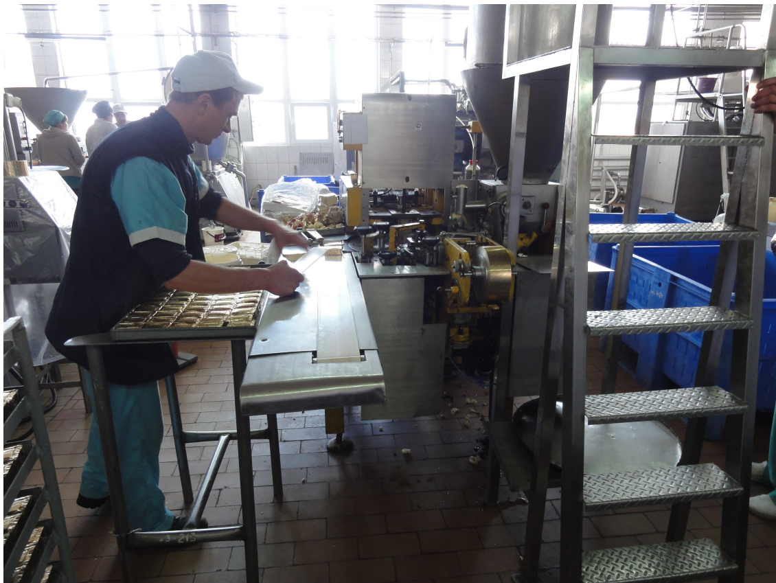
3.7. Фасування плавленого скибкового сиру
