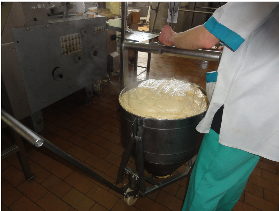
3.5. Вивантаження розплавленої сирної маси із котла-плавника
