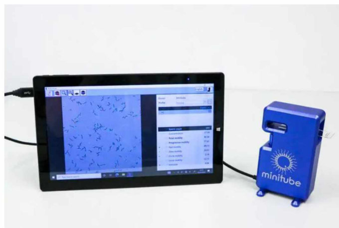
Рис.3.6. Система CASA IVOS II компанії Minitube
