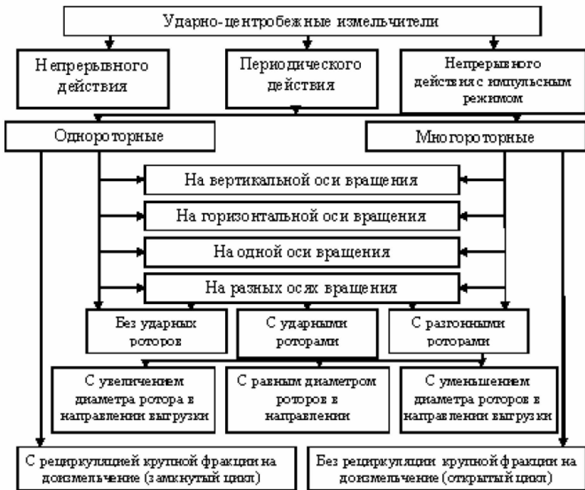
Рис. 1.2 – Класифікаційна схема ударно-відцентрових подрібнювачів
