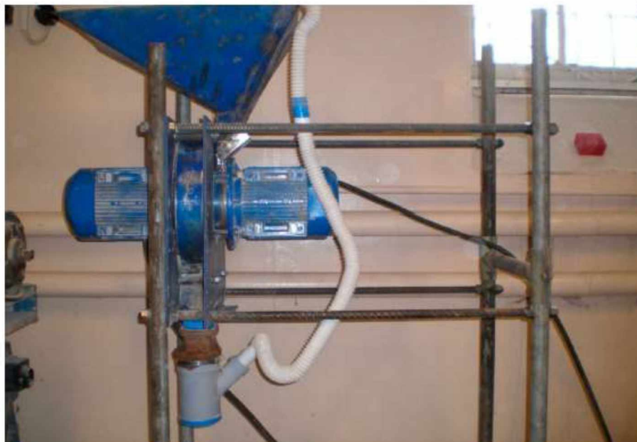
Рис. 2.7 – Експериментальна установка ударно-відцентрового подрібнювача
