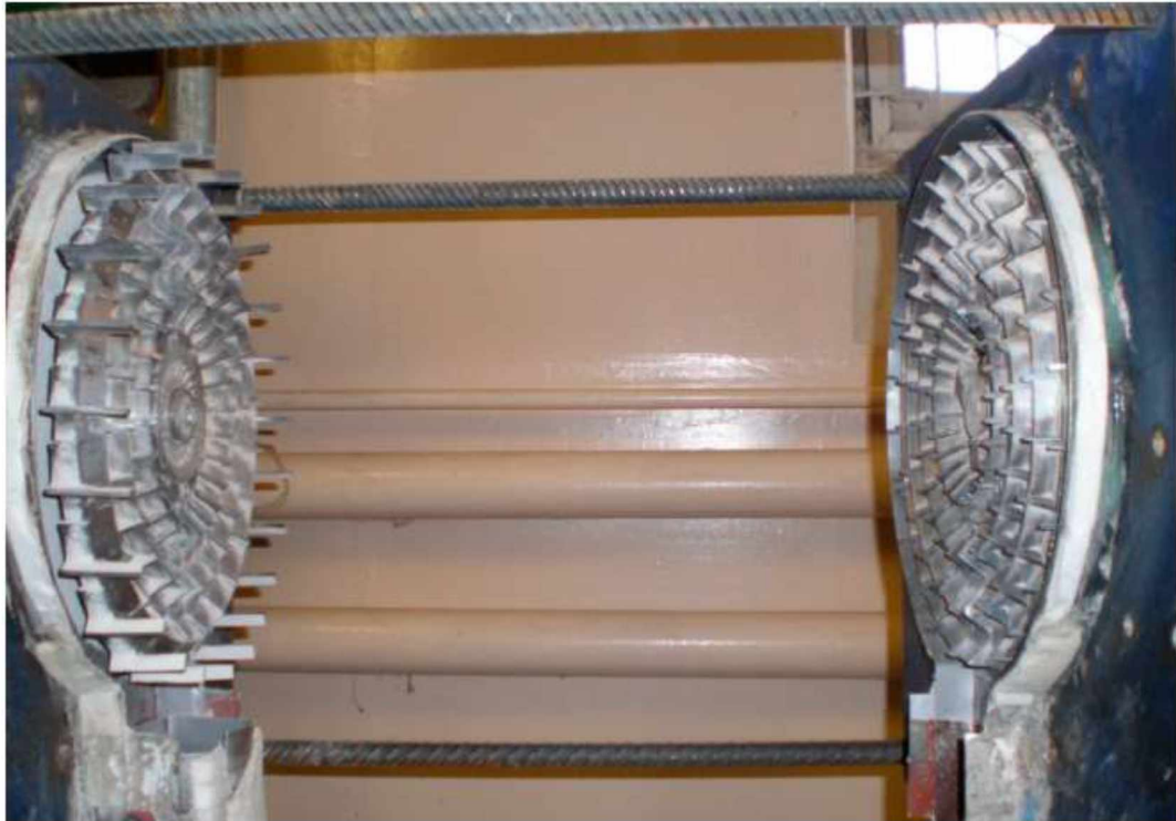
Рис. 2.8 – Розбірний вид ударно-відцентрового подрібнювача
