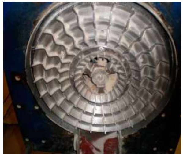
Рис. 2.10 – Права половина подрібнювача із завантажувальними вікнами
