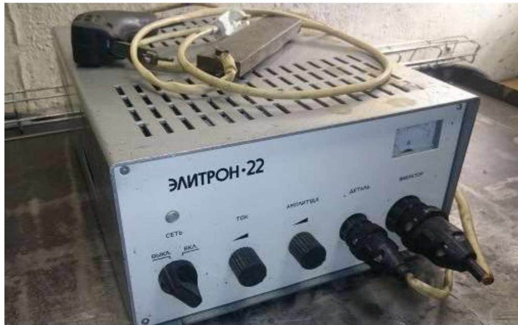
Рисунок 2.2 – Загальний вигляд установки для електроіскрової обробки
