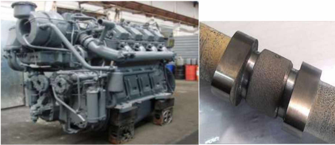
Рисунок 1.6 – Дизельний двигун та кулачковий вал з відновленими електродуговою металізацією поверхнями
