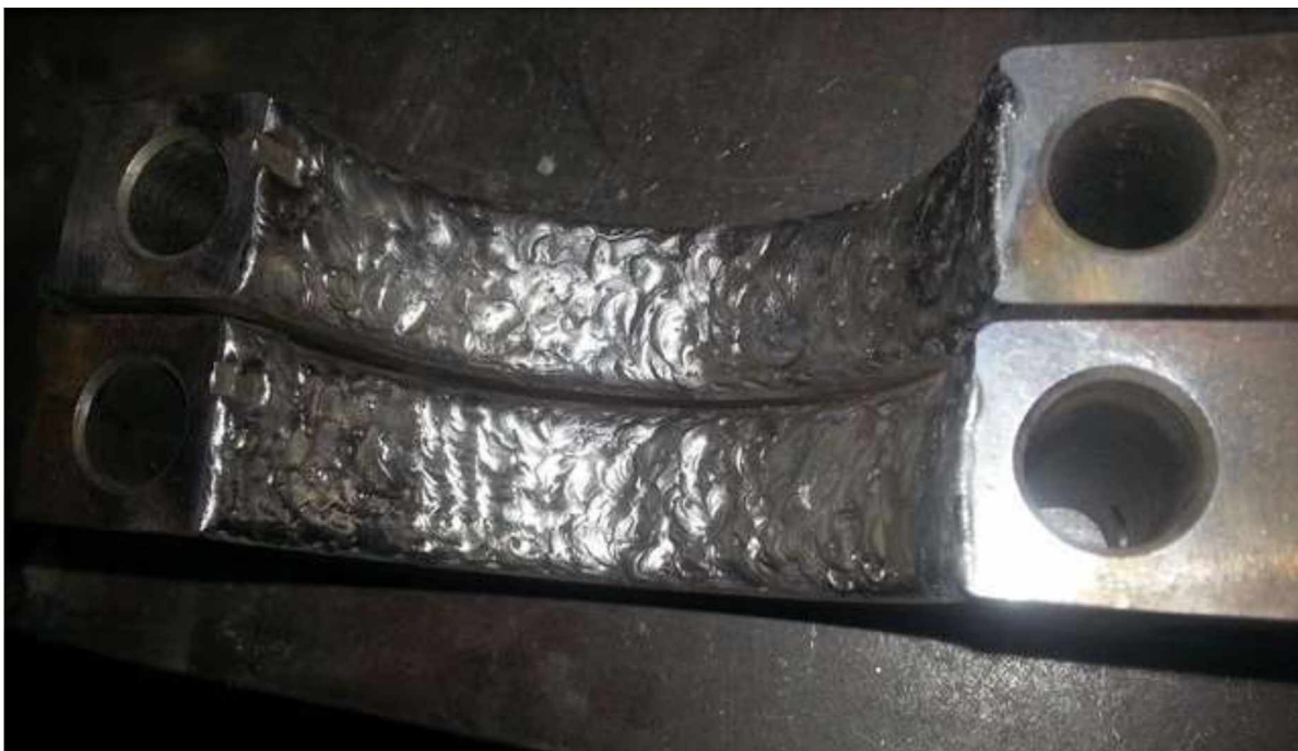
Рисунок 1.3 - Наплавлення «ліжок» колінчастого валу до розточування
