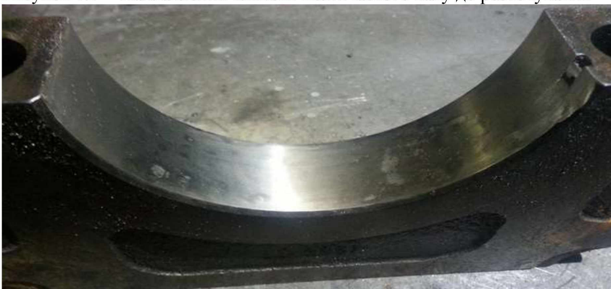
Рисунок 1.4 - «Ліжка» колінчастого валу після розточування під потрібний розмір.
