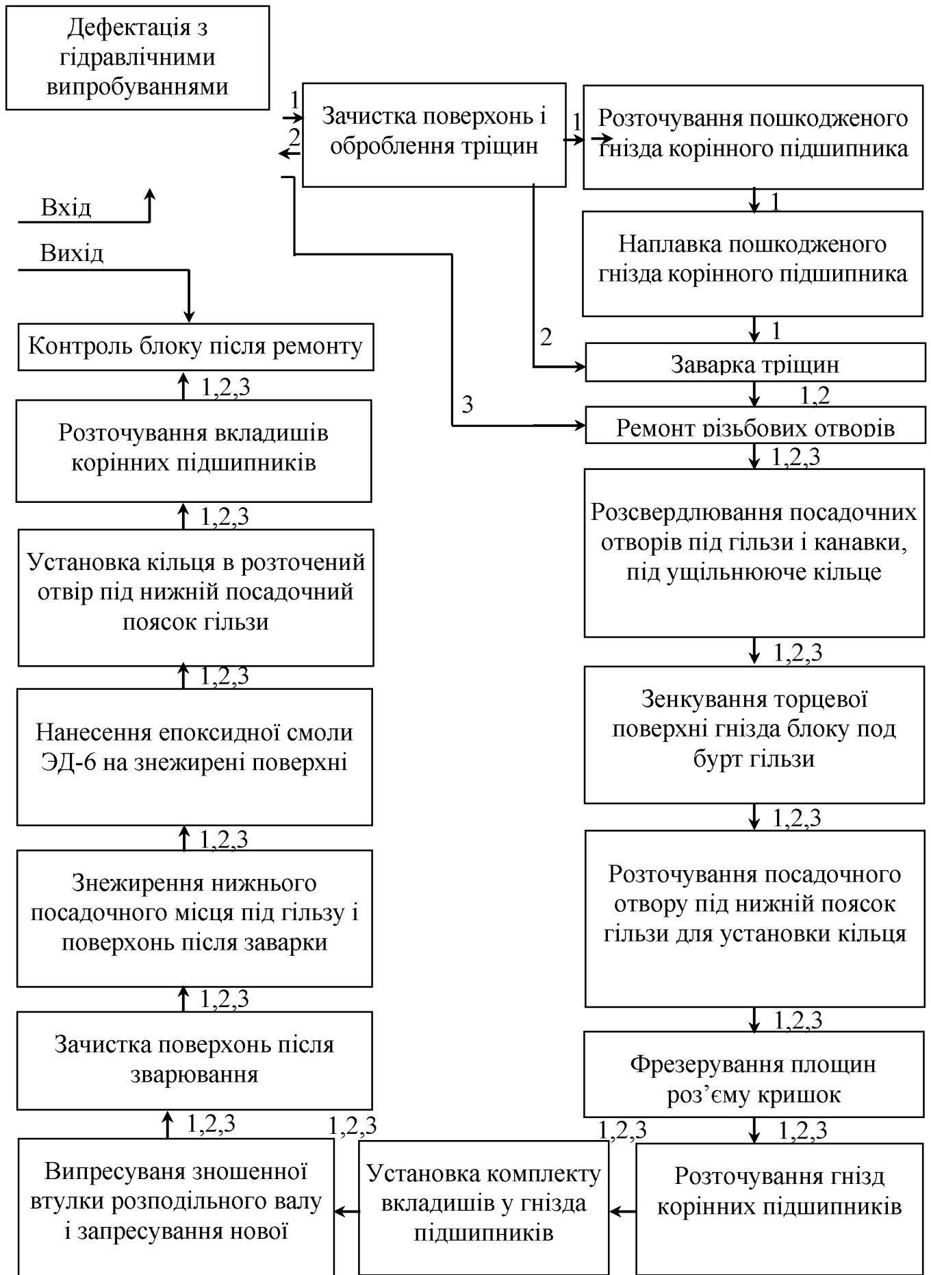
Рисунок 1.3 - Схема технологічного процесу ремонту блок-картера: 1, 2, 3 – маршрути ремонту.
