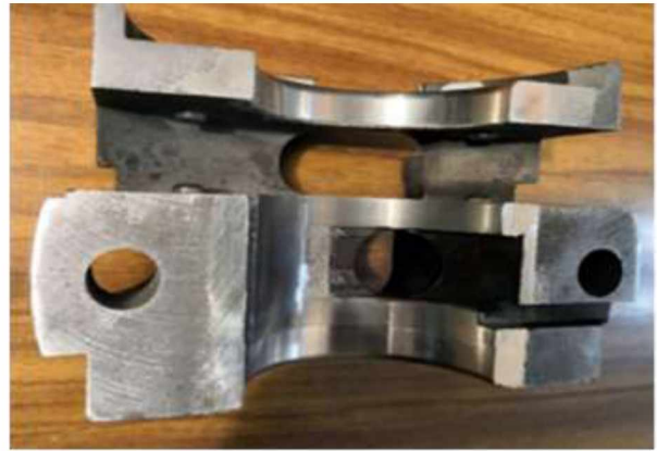
Рисунок 3.5 – Відновлені електродуговою металізацією поверхні вкладишів
