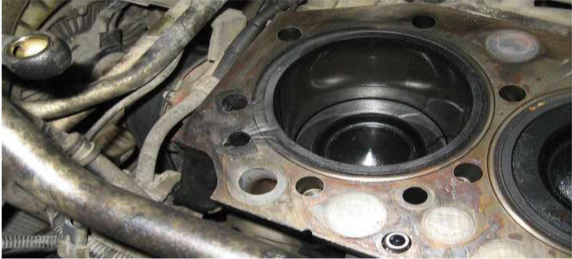
Рисунок 1.2 - Дефекти на площині роз'єму головки і блоку циліндрів
