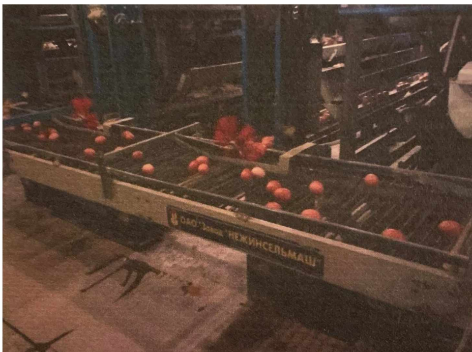
Рис. 3.14. Ліфт для транспортування яєць до сортувального відділення
