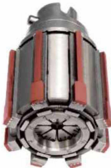
Рисунок 2.3 – Інструмент для нанесення композитних покриттів на основі заліза на внутрішні циліндричні поверхні
