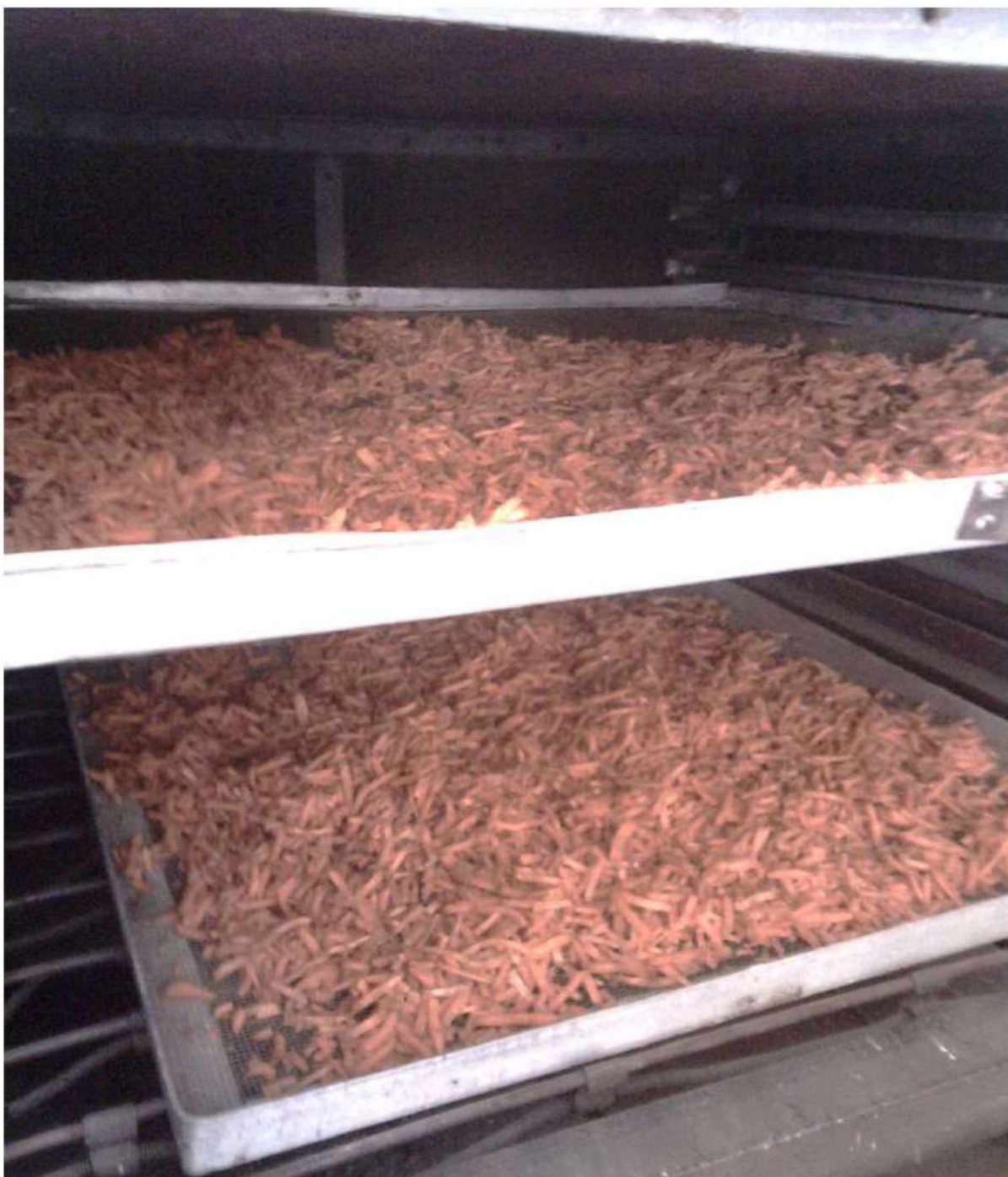
Рисунок 2.6 - Загальний вигляд сушильної камери виробничо-експериментальної ІЧ-установки в процесі сушіння коренеплодів
