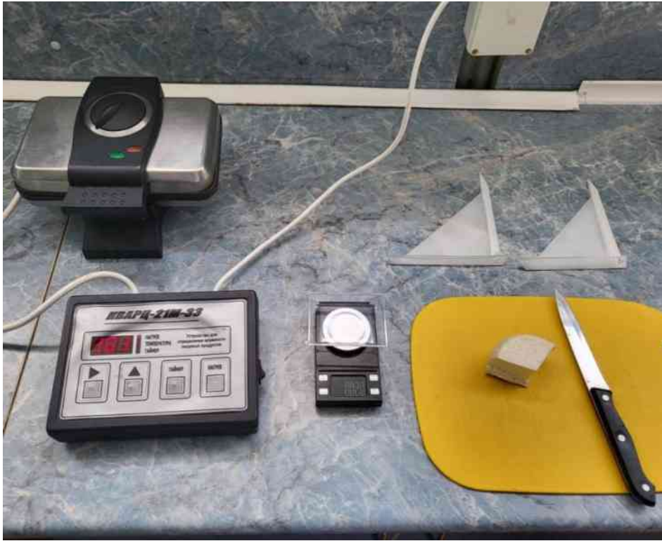
Рис. 3.12. Прилад Чижової для визначення вологи в сирі
