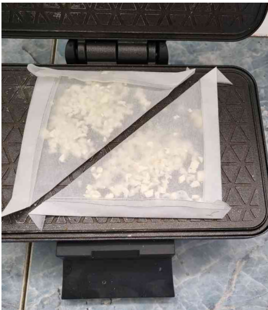
Рис. 3.14. Укладання проби до дослідження в прилад Чижової
