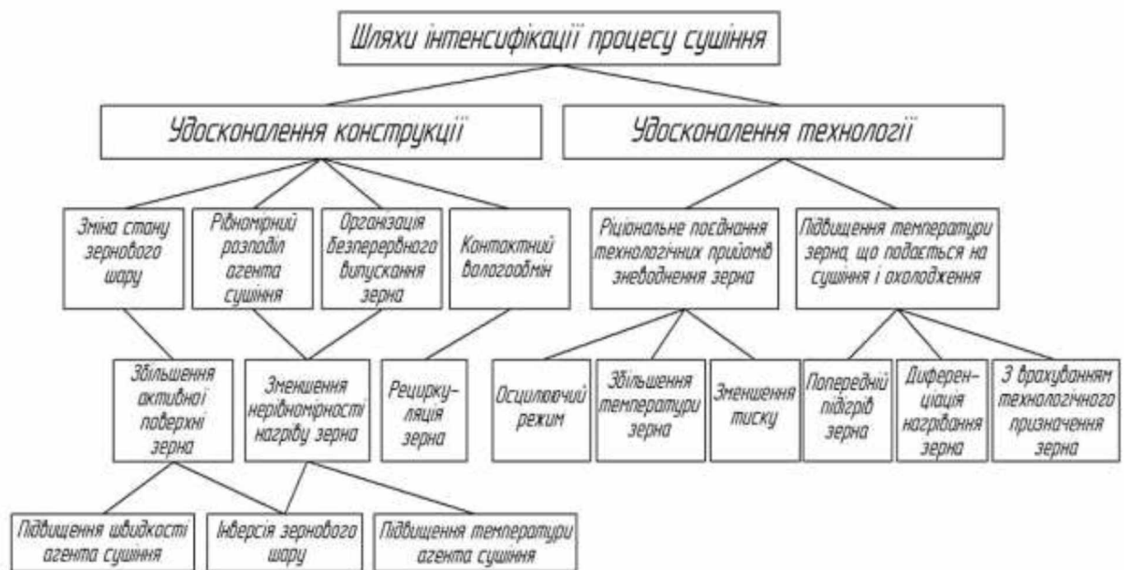
Рисунок 1.10 – Класифікація шляхів інтенсифікації процесу сушіння зерна
