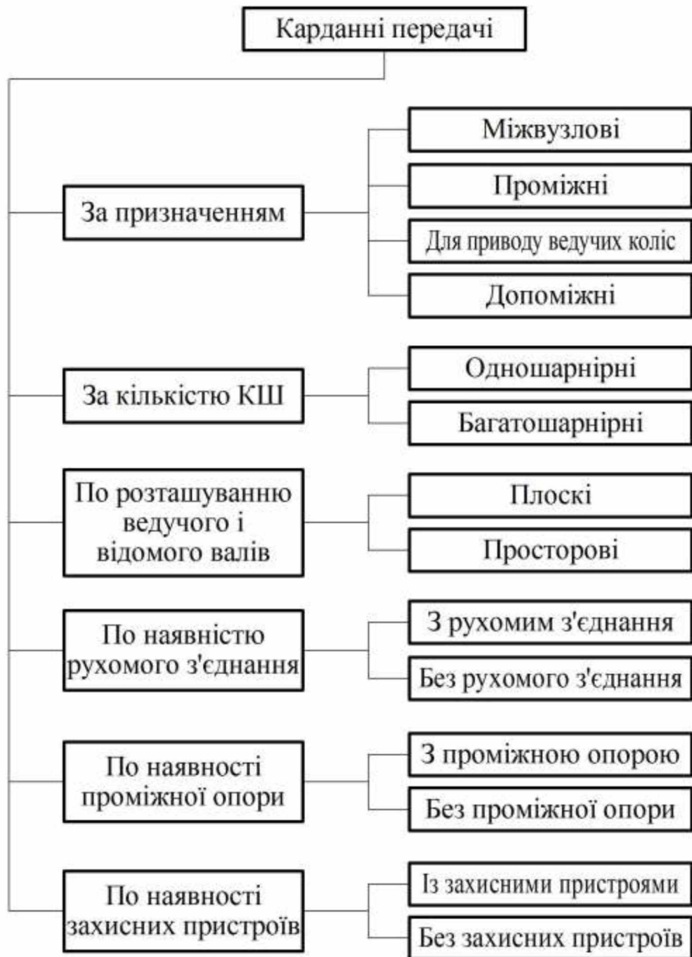
Рис. 1.2 – Класифікація карданних передач СГТ
