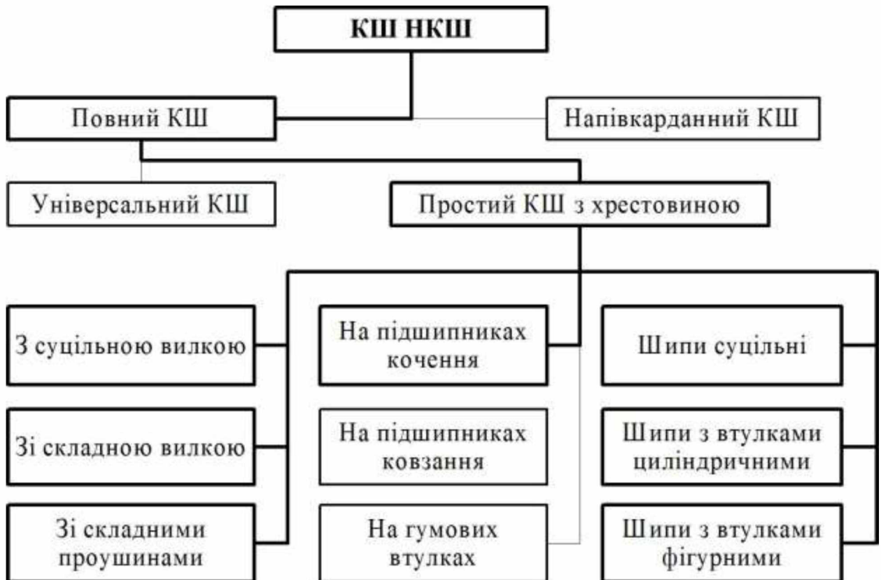
Рис. 1.3 – Класифікація карданних шарнірів нерівних кутових швидкостей
