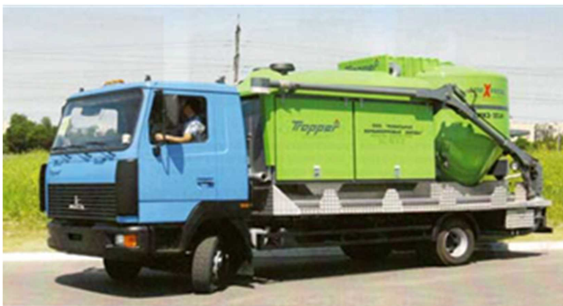
Рис. 3.4. Мобільний комбікормовий агрегат.
