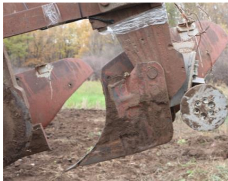
Рис. 1– Плоско-округлий елемент у вигляді диску зі ступицею встановлений замість польової дошки на третьому корпусі лемішного плуга ПЛН-3-35
