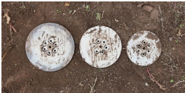
Рис. 2 – Плоско-округлі елементи у вигляді дисків діаметром 170 мм, 200 мм і 230 мм замість стандартної польової дошки начіпного плуга ПЛН-3-35
