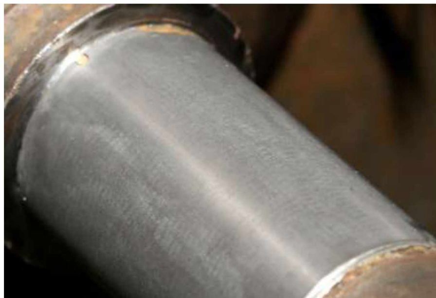
Рисунок 2.8 – Відновлена поверхня валу після шліфування
