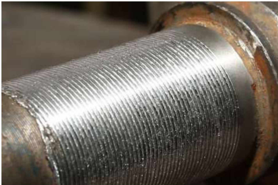
Рисунок 2.6 – Зношена поверхня вала після електромеханічної обробки
