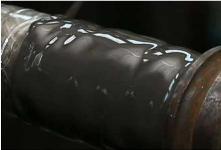
Рисунок 2.7 – Поверхня валу після полімеризації композиції
