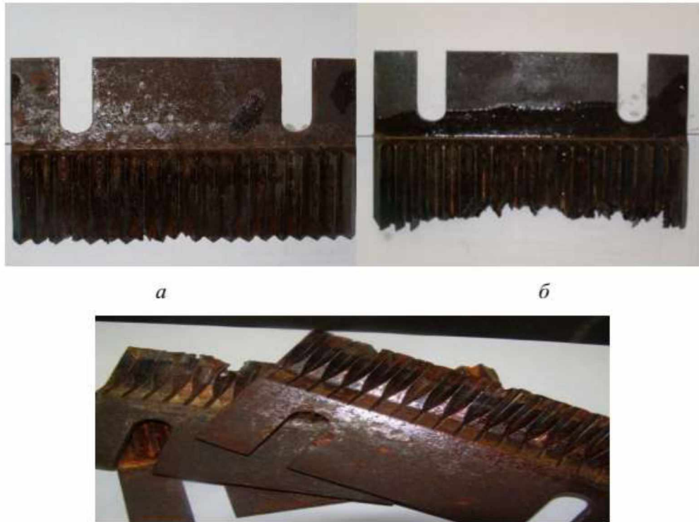
Рисунок 1.6 – Руйнування різальних кромок: а - викришування; б - вирив; в - деформація ромбовидної грані
