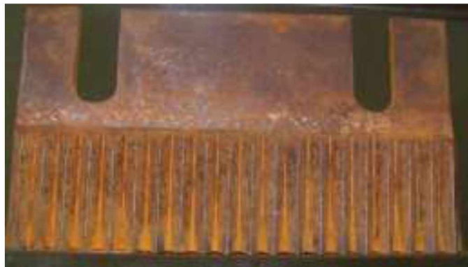
Рисунок 3.3 – Ніж, виготовлений механічною обробкою
