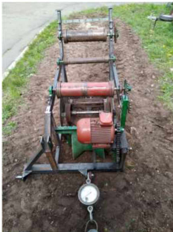
Рисунок 2.3 – Визначення опору руху лемеша
