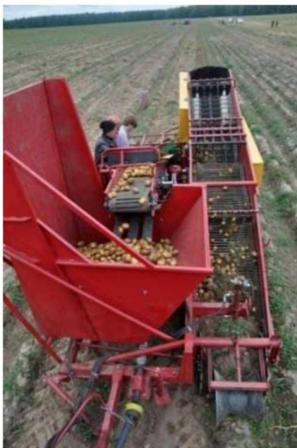
Рисунок 1.2 – Однорядний картоплезбиральний комбайн
