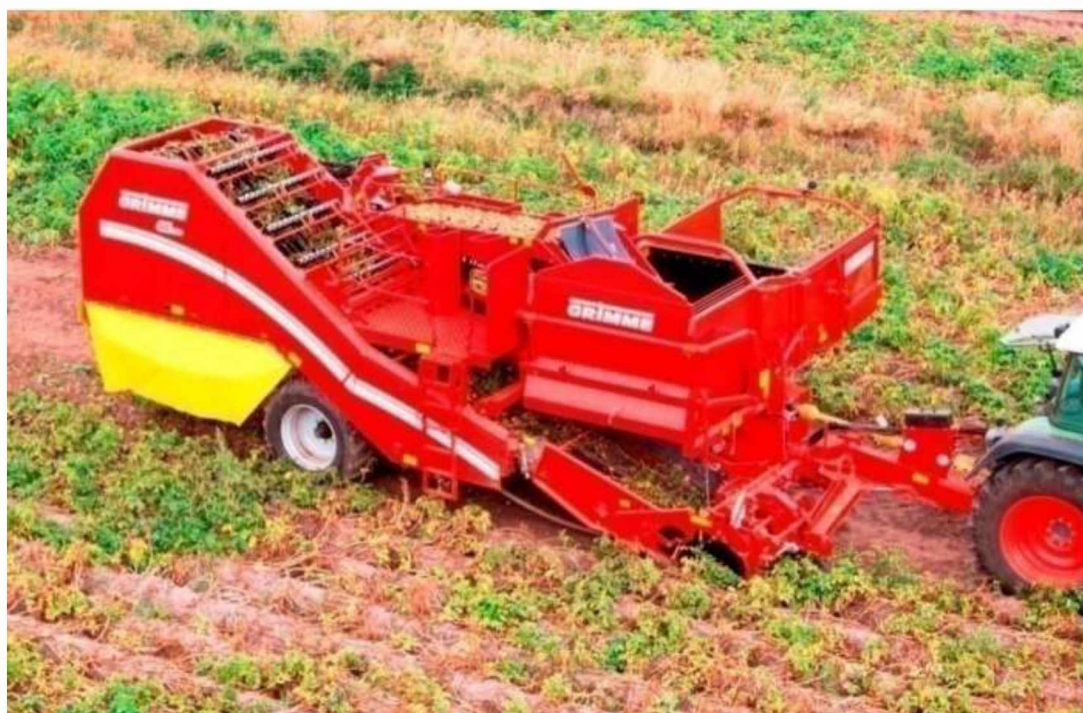
Рисунок 1.3 – Однорядний картоплезбиральний комбайн Grimme SE 75
