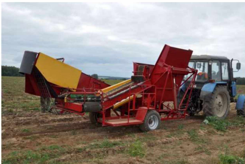
Рисунок 1.2 – Однорядний картоплезбиральний комбайн
