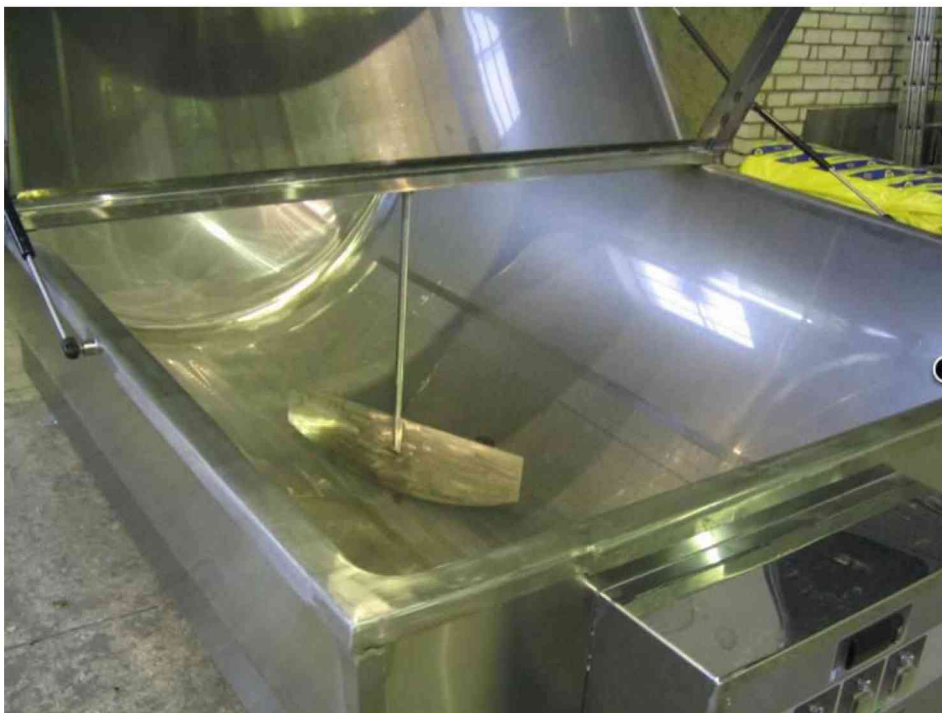
Рисунок 3.3. Вмонтована мішалка в горизонтальному охолоджувачі
