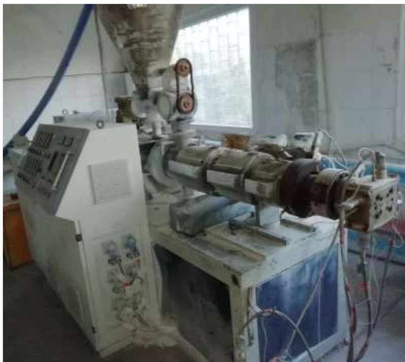
Рисунок 2.3 – Загальний вигляд екструдера Матеріал транспортується черв'яком по гвинтовому каналі циліндра.
