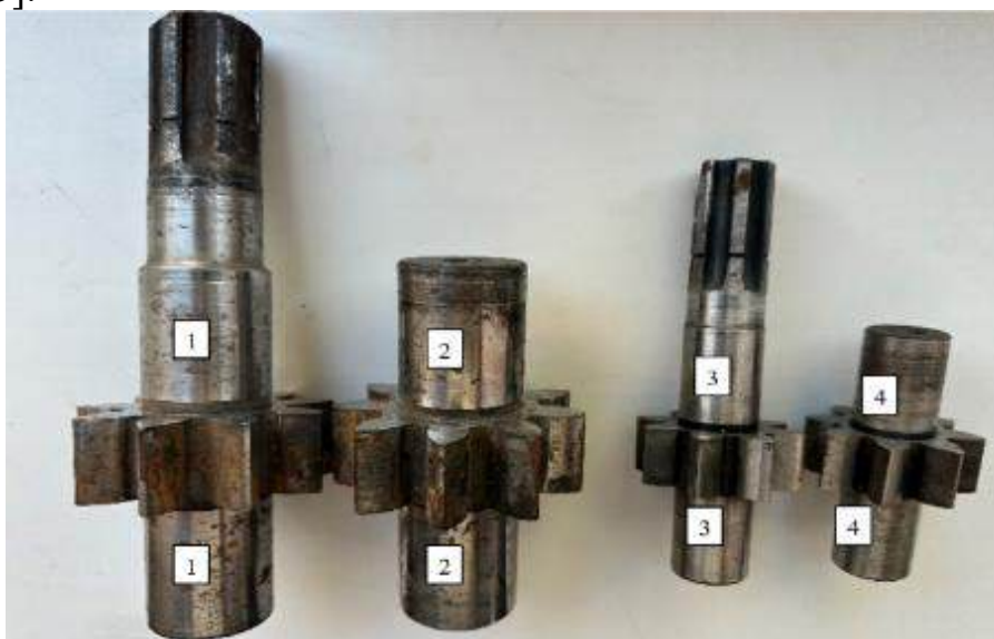
Рис. 3. Приклади зношування робочих поверхонь тертя на валах насосів типу НШ-100 (праворуч) та НШ-32 (ліворуч): 1 – сліди зношування приводного валу НШ-100; 2 – сліди зносу веденого валу НШ-100; 3 – сліди зношування приводного валу НШ-32; 4 – сліди зношування веденого валу
