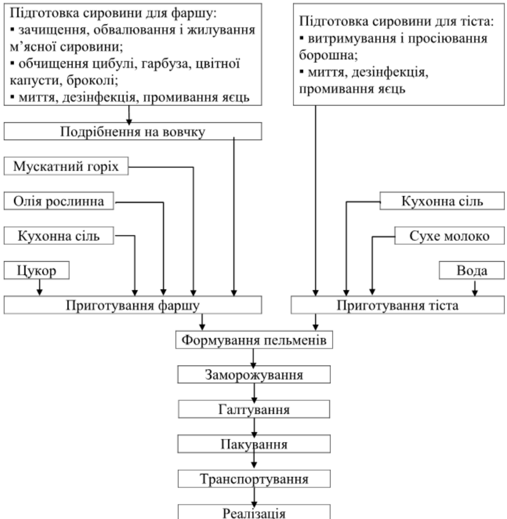
Рис 3.5. Технологічна схема виробництва заморожених м'ясних напівфабрикатів (пельменів), [3]
