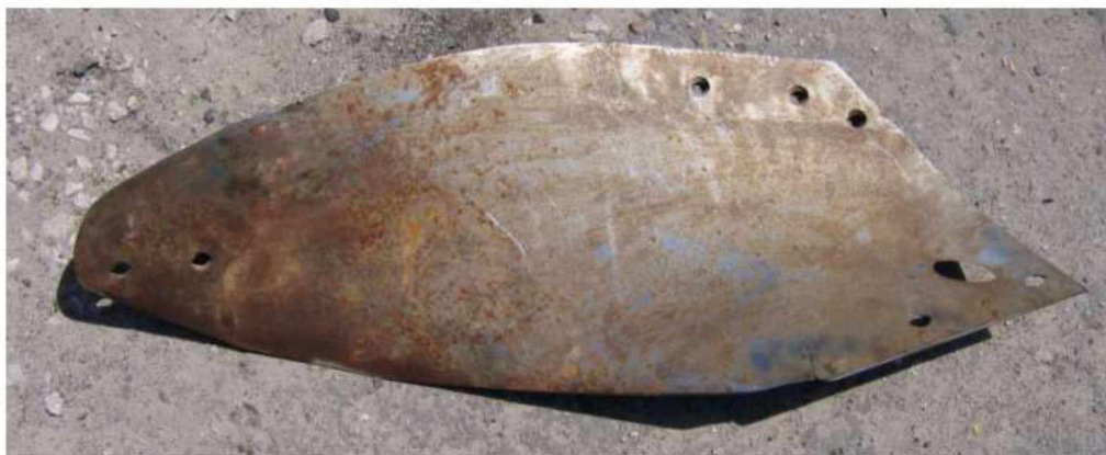
Рис. 1.4 – Наскрізне зношування площини відвалу плуга Gregoire Besson
