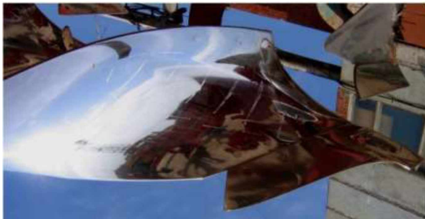
Рис. 3.9 – Вид зношеного відвалу (крейдою штриховий лінією обведена зона найбільшого зношування грудей відвалу)
