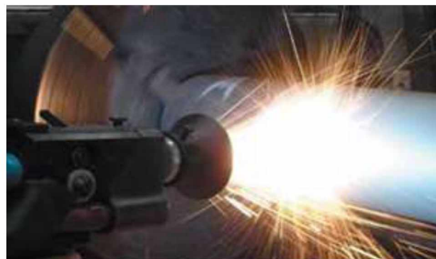
Рисунок 1.8 – Схема установки для лазерного наплавлення
