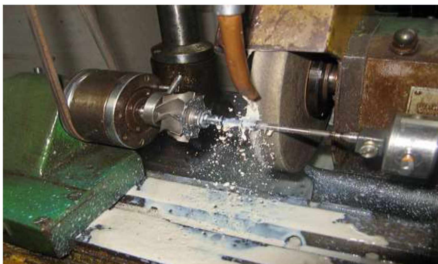
Рисунок 1.6 – Технологічний процес шліфування валу ротора
