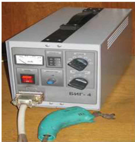
Рисунок 2.2 – Установка для електроіскрового відновлення БІГ-4
