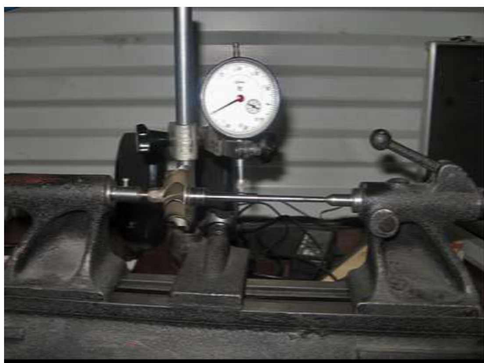
Рисунок 2.1 – Перевірка величини биття валу ротора.
