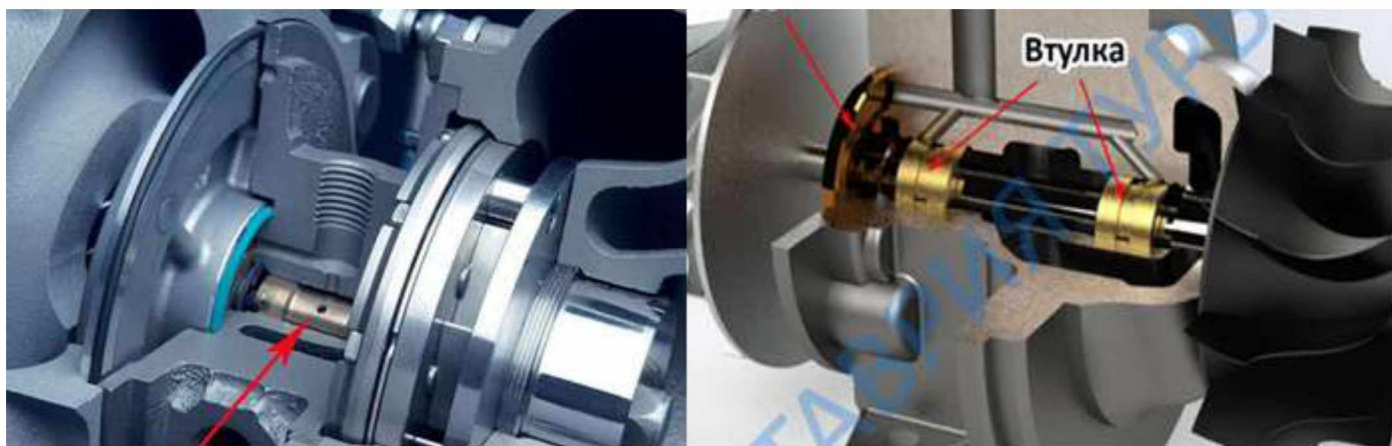
Рисунок 1.4 – Підшипники ковзання (втулки) ротора турбокомпресора
