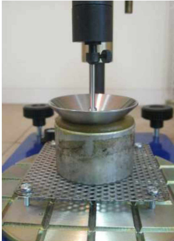
Рисунок 2.6 – Вимірювання пенетрації мастильного матеріалу приладом М-984ПК
