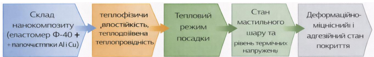
Рисунок 2.9 – Узагальнена схема впливу теплофізичних характеристик нанокompозиту на ресурс вузла «корпус – підшипник»
