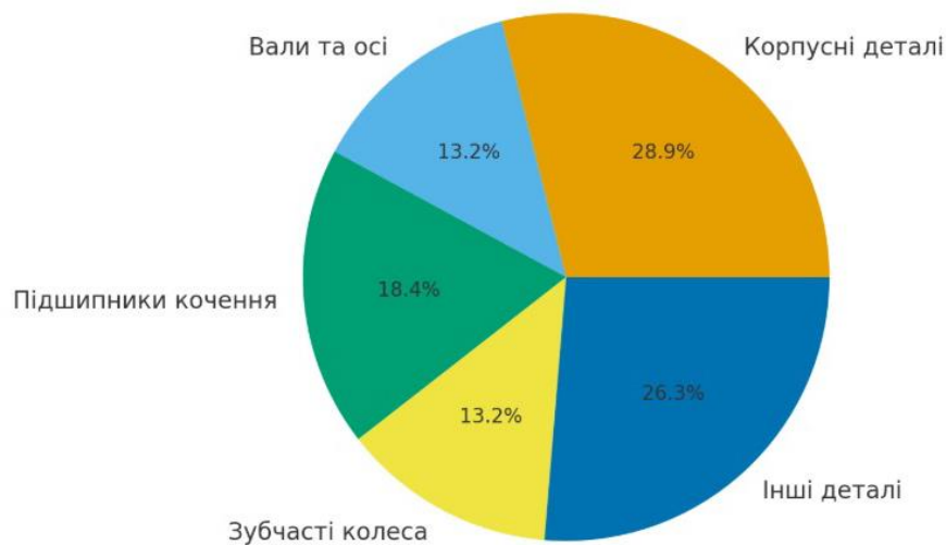
Рисунок 1.1 – Структура витрат на ремонт вузлів машинно-тракторного парку
