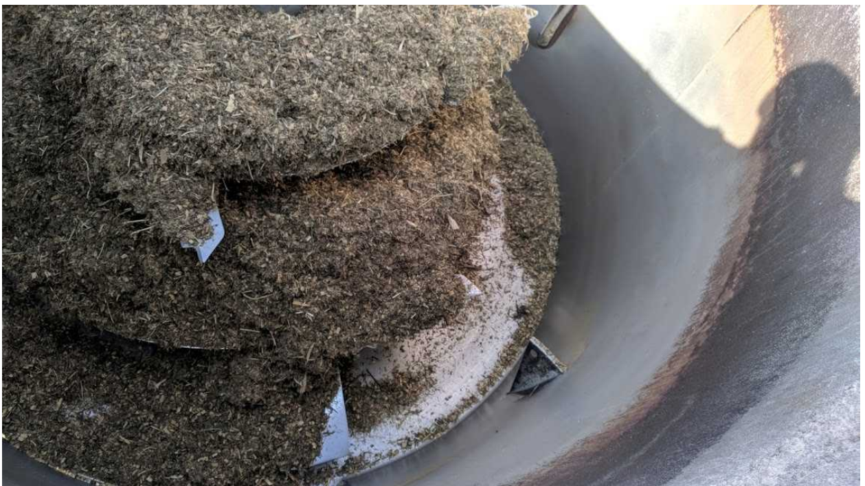
Рис. 3.8. Перемішування компонентів кормосуміші в чаші корморозавача-змішувача
