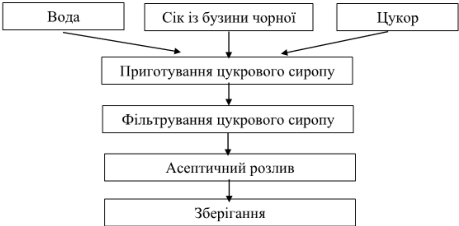
Рисунок 3.3 – Технологічна схема виробництва цукрового сиропу з бузини чорної
