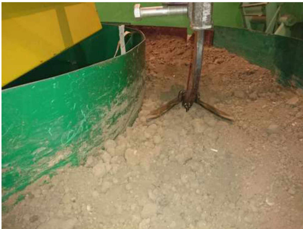
Рисунок 2.8. – Фото кріплення стійки на лабораторній установці
