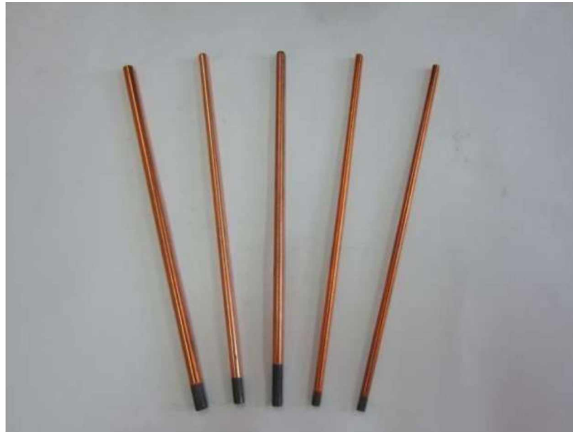
Рисунок 2.2 – Вугільні електроди, що використовуються при КВДЗ
